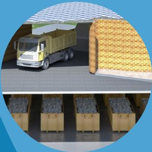
In questa versione l'impianto è interrato, con un sistema di carico per mezzo di una botola esterna, all'interno della quale verrà riversato il materiale da smaltire.
